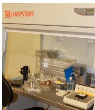
Ламинарный шкаф с системой нанесения проб на ленты масс-спектрометра и дегазатор лент
