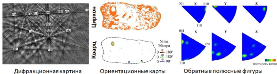
Микродифракционная картина Кикучи циркона метаморфитов Мугоджар, карты ориентаровок кристаллитов циркона и включений кварца, распределение ориентировок на обратных полюсных фигурах [Замятин, Щапова, Вотяков. Ежегодник ИГГ, 2014, 2015]
